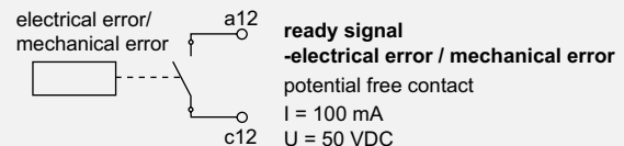
Output circuit SE...V11 / SE...V13 and SE...E50 V11 / SE...E50 V13
